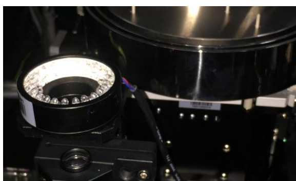
Дополнительная камера верхнего обзора держателя для совмещения зонда и платформы
